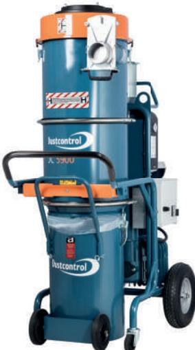
Der größte der mobilen DC-Asbestflotte mit starkem 9,2 kW-Motor. Ein hoher, langer Zyklon ist Garant für optimale Fliehkraft-Abscheidung ohne die Filter zu belasten. Die große Filterfläche von 8,4 m² mit 99,9 % Abscheidungen des Feinstaubes, sowie der große Mikrofilter von 3,7 m² mit 99,995 % Abscheidung fangen die kleinsten Schwebeteilchen ein. Ein stabiler Plastiksack mit 75 Liter Volumen sammelt das abgesaugte Material.
