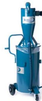
Dieser Vorabscheider ist mit einem zusätzlichen effektiven Zyklon ausgerüstet. Aufgrund seines Durchmessers, seiner verhältnismäßig großen Höhe und des speziell ausgeführten Einlasses kann er auch feines und leichtes Material, wie z.B. Asbestfasern abscheiden. Das abgeschiedene Material gelangt direkt in einen Plastiksack für eine staubfreie Entsorgung.
