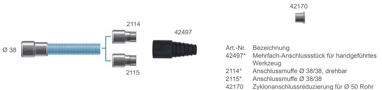
Das Mehrfach-Anschlussstück passt auf Absaughauben mit einem Anschluss von 25-35 mm (Außendurchmesser). Es wird einfach am entsprechenden Durchmesser (mit 25, 27, 29, 31, 33, 35 mm gekennzeichnet) abgeschnitten. An das andere Ende passen die Anschlussmuffen 2115 und 2114.
