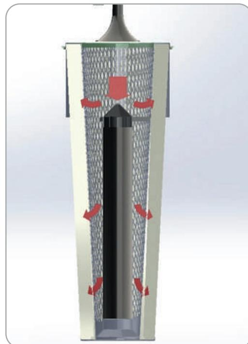
Filterreinigung mit Filter-Reinigungs-Optimierer
